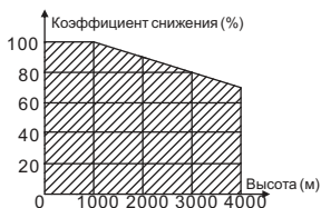
Рисунок 3-3. Снижение номинальной мощности преобразователя частоты GD20 в зависимости от высоты над уровнем моря.
