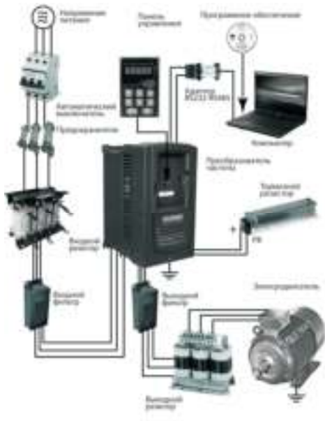
Рис. 12-1. Схема подключения дополнительного оборудования
